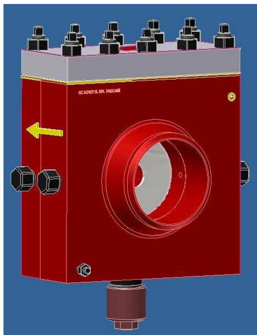
Fig.3-Port-diafragmă cu flanșă cu gât în amonte și flanșă cu gât în aval (vedere)
