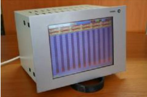
CAOM IDMC 04 est un dispositif numérique programmable, conçu comme système de matériel-logiciel pour l'automatisation de processus. Il remplace le vieux stylo et les enregistreurs de papier.
